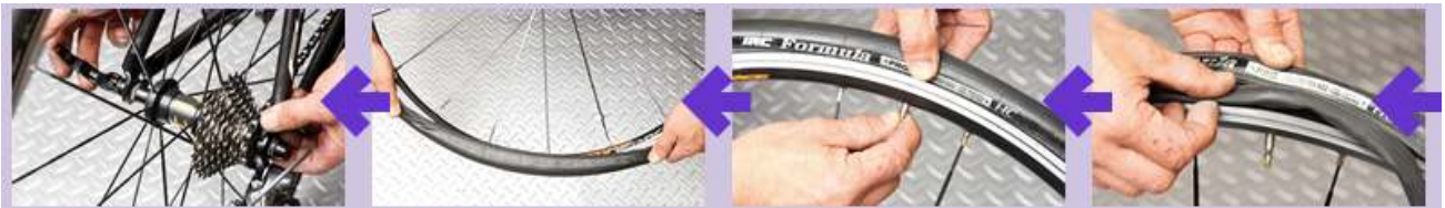
ホイールを戻してクイックを閉める
