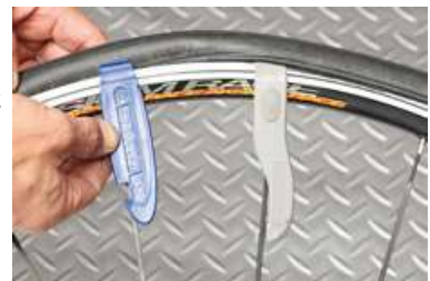
●フック形状でスポークに固定できるタイプ(右)、ビードを引っ掛ける部分が幅広で平たいタイプ(左)。使い勝手に違いがある
